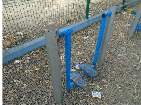
**13. Reparación y pintura general en máquina caminadora #2 (incluye cambio de accesorios en pivotes o ejes).**
