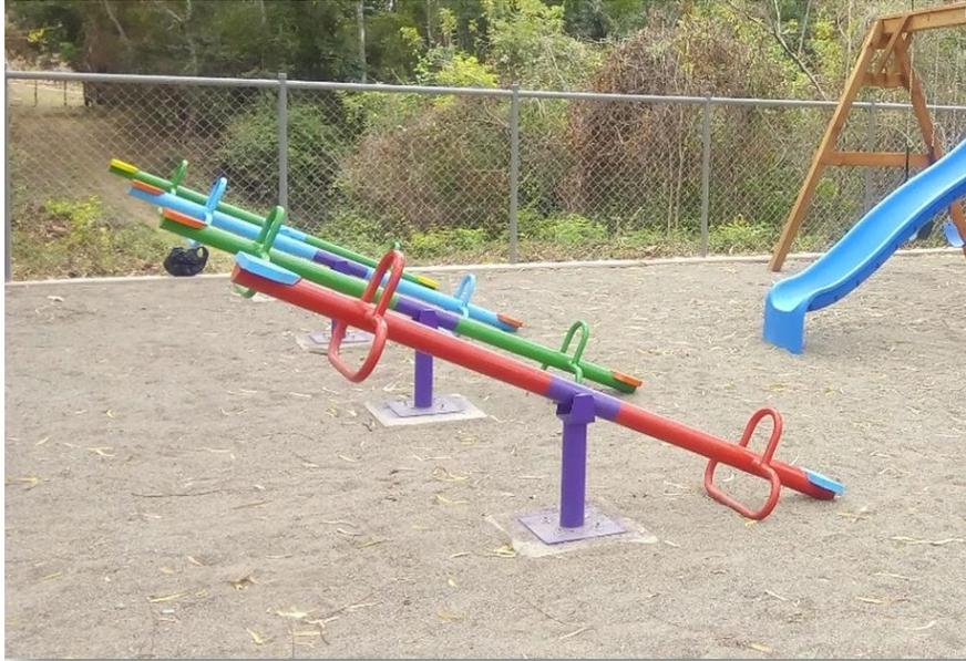
**SUBE Y BAJA:** Estructura principal con tubería de hierro diámetro de 3" x 3.25 mm de espesor, largueros de diámetro 2" x 3,25mm de espesor, asideros caños de diámetro 1", asientos plásticos anatómicos anti-golpes y resistentes, capacidad 2 niños por sube y baja, pintura sintética resistente a altas temperaturas del tipo *FAST DRY*.
