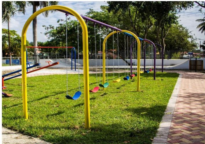
**COLUMPIO:** Estructura fabricada con tubo metálico de 3" chapa 14 doblado en dobladora industrial, travesaño horizontal de 3", recubiertos con una mano de pintura anticorrosiva y luego con pintura *Fast Dry* según colores indicados por Supervisor, 6 asientos plásticos, cadena galvanizada con cobertores plásticos sujetos al travesaño con sistema de balinera, postes fundidos en concreto con crucetas soldadas en los extremos. Ver imagen
