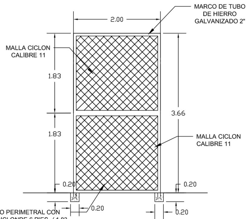
CERCO PERIMETRAL CON MALLA CICLON DE 6 PIES (1.83 MTS) , Y VARILLA N°3 TODOS LOS ELEMENTOS SOLDADOS INCLUYE FUNDICION DE TUBO DE HIERRO GALVANIZADO 2"
