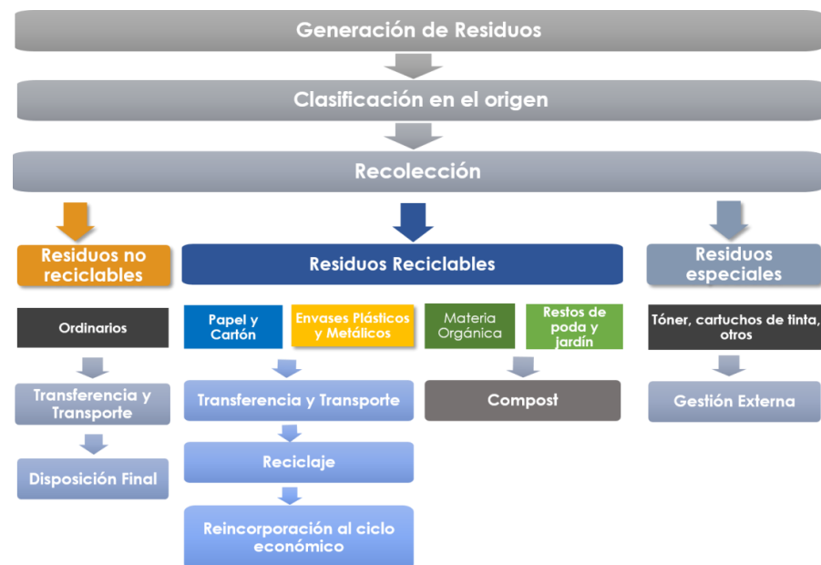
Figura 1. Diagrama del modelo de gestión de residuos sólidos a ser implementado en el Edificio No. 3
