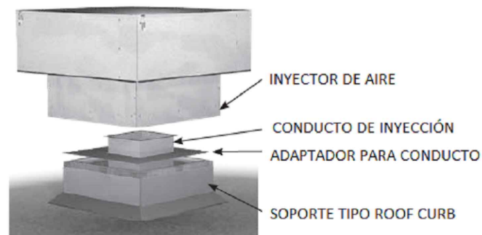
04 DETALLE DE SOPORTES Y ANCLAJES PARA INYECTORES DE AIRE DE TECHO ESCALA: N/A
