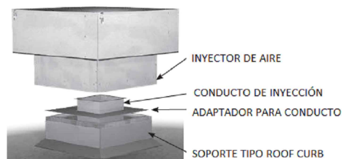
04 DETALLE DE SOPORTES Y ANCLAJES PARA INYECTORES DE AIRE DE TECHO ESCALA: N/A
