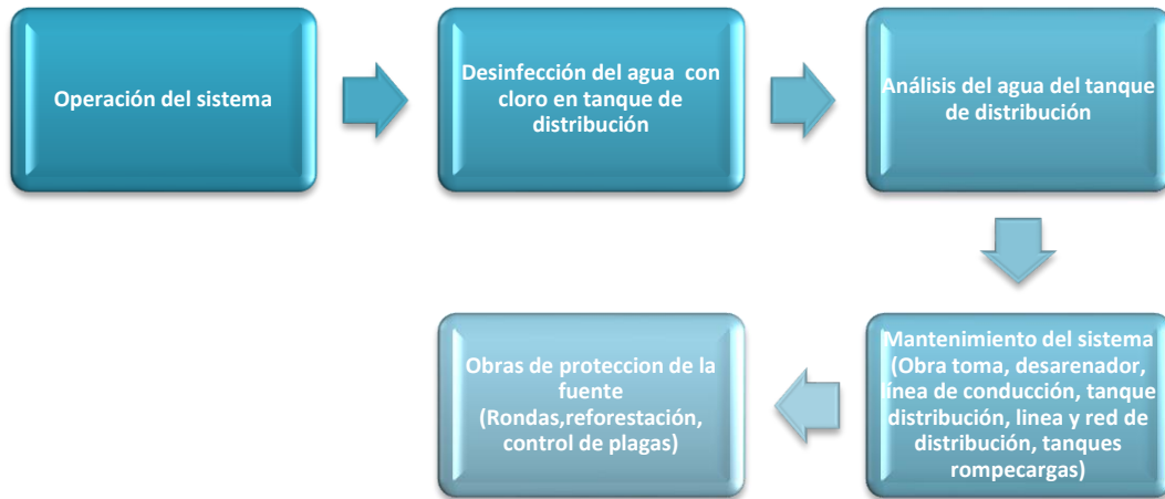
Ilustración 2. Flujograma del proceso operativo del proyecto “Ampliación del sistema de agua potable y saneamiento El Cerrón y Las Crucitas”
