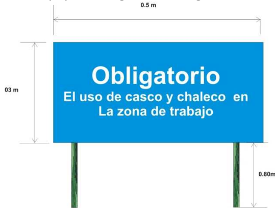
Rotulo de uso obligatorio de equipo de seguridad e higiene con dimensiones
