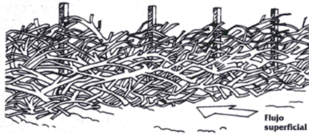
Cerca de maleza, enterrada 10 cm dentro del suelo.
