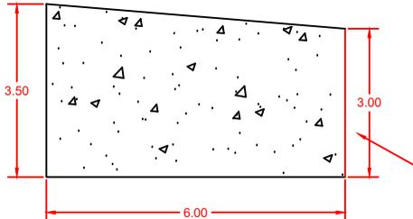
ALETA CONCRETO F'C 500PSI CONCRETO REFORZADO SEGUN ARMADO ESTRIBOS A Y B
