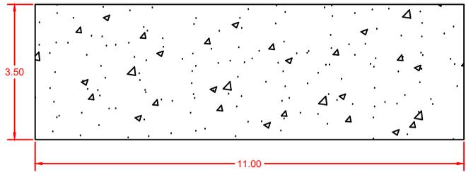
ALETA CONCRETO F'C 500PSI CONCRETO REFORZADO SEGUN ARMADO ESTRIBOS A Y B
