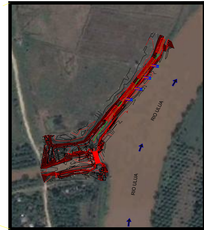
ESPIGONES DE GAVION SOBREELEVACION DE BORDO
