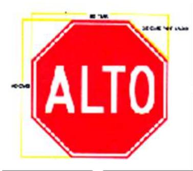
**R//** Las empresas oferentes deberán fabricar la señal vertical ALTO con una medida de 61 cms por 61 cms por 25 cms cada lado. El tubo deberá tener una altura de 2(dos) mts libre desde la base de la señal hasta la superficie de la acera y 40 cms de profundidad.
