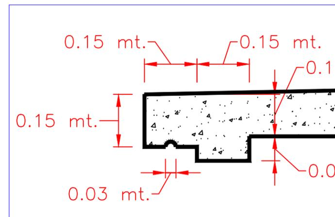
**DETALLE BORDE LOSA DE TECHO**
