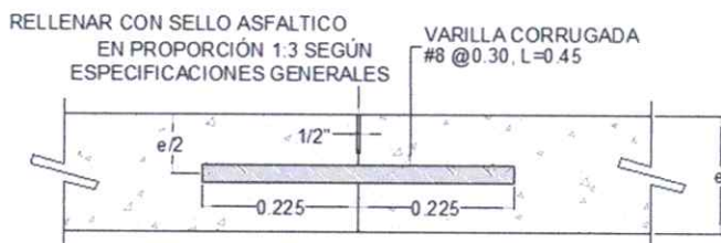
DETALLE DE JUNTA TRANSVERSAL DE CONSTRUCCIÓN AL FINAL DE LA JORNADA ESCALA: 1:10
