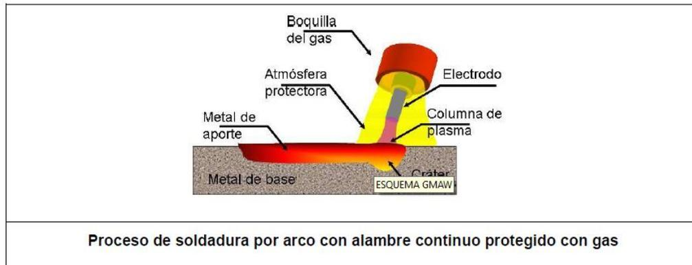
Este proceso puede aplicarse de forma semiautomático, mecanizada y automática y por medio de robot, es adecuado para operaciones repetitivas como las empleadas en la industria automotriz.
