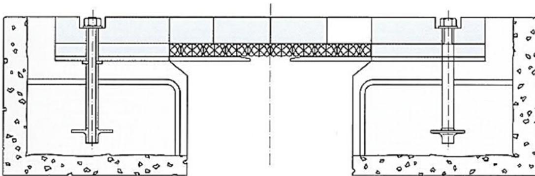
Fig. 3: Tipo 3 con perfil de elastómero.
