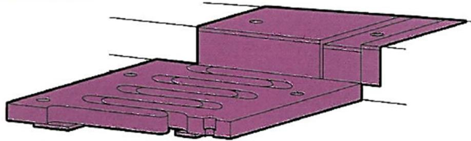
Fig. 2: Cubierta de bordillo.
