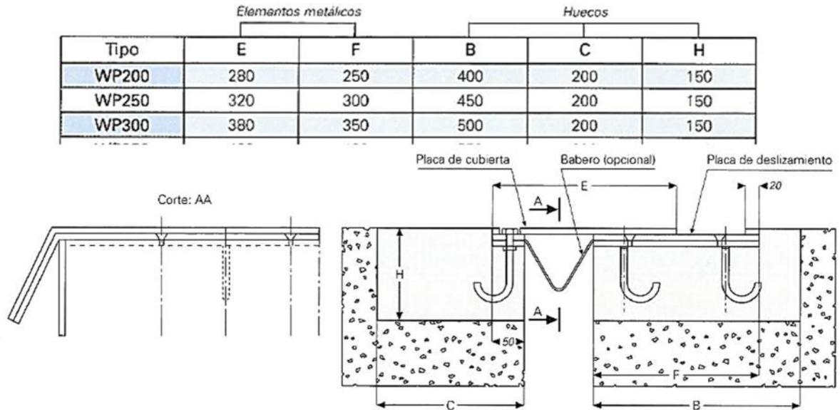
Fig. 1: Junta de acero.
