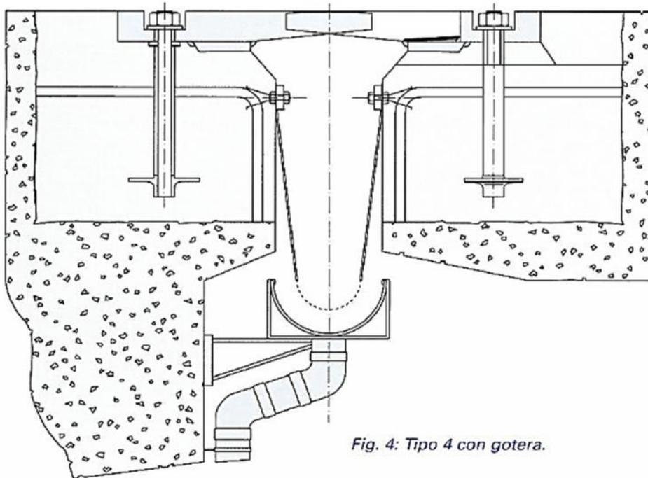
Fig. 4: Tipo 4 con gotera.
