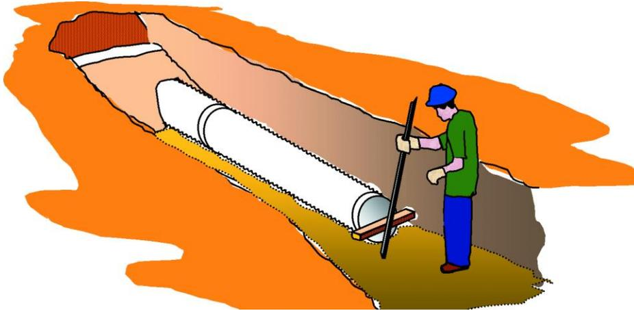
4. La tubería de PVC de doble pared se suministra en longitudes de 6.0 m, sin embargo es frecuente cortarla para alcanzar las longitudes exactas de cada tramo, o para colocar accesorios. Los cortes deben hacerse lo más recto posible, siempre en los valles. A continuación elimine los rebordes con una lima.
