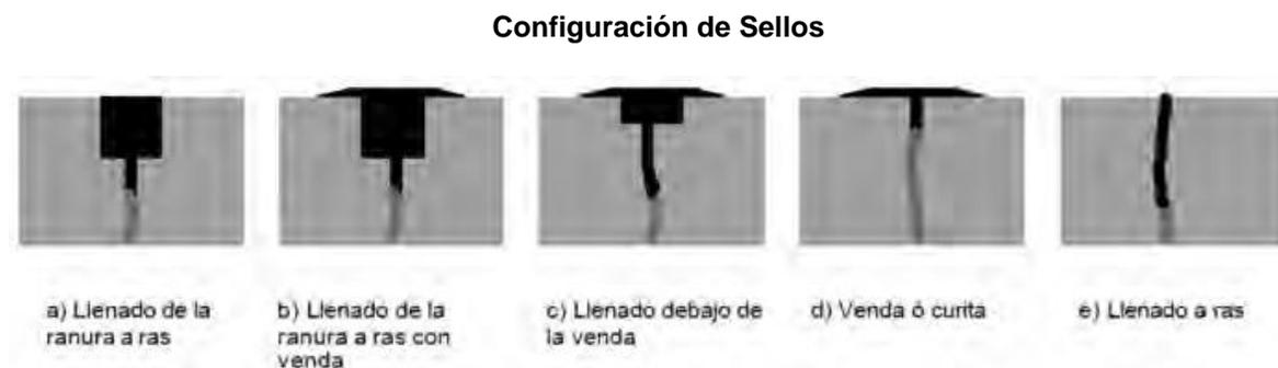
Los sellos tipo venda o curita deben tener un espesor aproximado de 0.125 pulgadas (3 milímetros) y un ancho mínimo de 3 pulgadas (75 milímetros).
