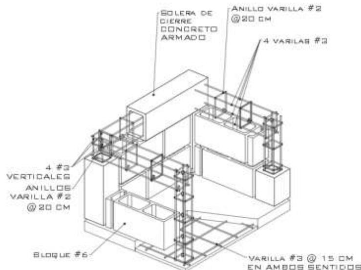
La construcción de la pileta de aseo contempla la fundición de un firme, la construcción de castillos y una solera de cierre, la actividad debe incluir la instalación de una coladera, un grifo y la colocación de enchape como revestimiento en la parte interna y externa con su respectivo esquinero protector de aristas.
