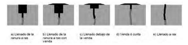
Los sellos tipo venda o curita deben tener un espesor aproximado de 0.125 pulgadas (3 milímetros) y un ancho mínimo de 3 pulgadas (75 milímetros).
