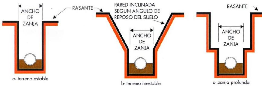
A partir de 2.00 m de profundidad, independientemente de la estabilidad del suelo y la forma de la zanja, se recomienda utilizar ademes de tipo abierto o cerrado, según sea el caso (**Fig.C**).
