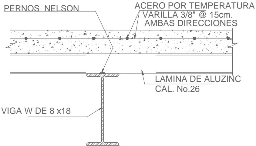
DETALLE DE CONEXION DE LAMINA Y VIGAS
