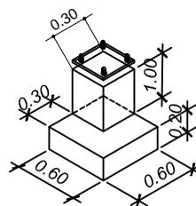
DETALLE DE UNIÓN DE COLUMNA Y PEDESTAL
