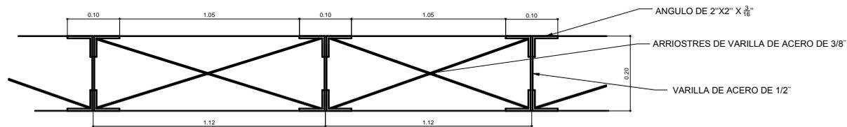
DETALLE VISTA TRANSVERSAL DE JOIST Y ARRIOSTRES
