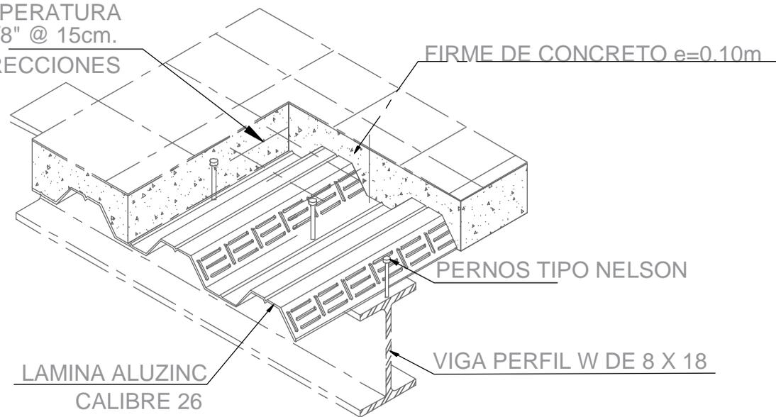
ISOMETRICO DE LOSA
