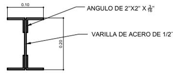
JOIST CON CUERDAS DE ÁNGULO DE 2X2" X  $\frac{3}{8}$ " Y ALMA DE VARILLA DE ACERO DE  $\frac{1}{2}$ "
