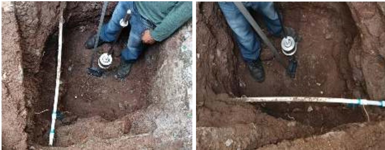
Figura 8 y 9: Vista de la zona al momento de realizar el ensayo DCP dentro de la calicata 1
