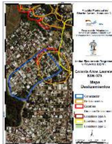
Figura 7: Mapa del área Intervención Colonia Altos de los Laureles con la orientación del deslizamiento color amarillo, color naranja deslizamiento y color rojo escarpe.
