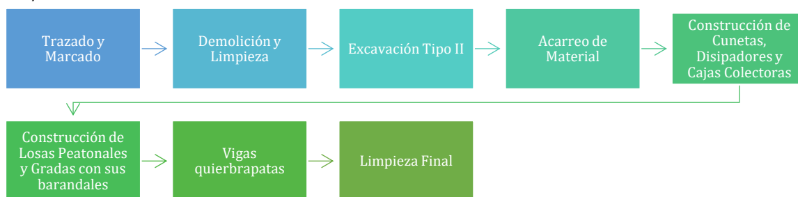
Figura 3. Actividades de Construcción del proyecto
