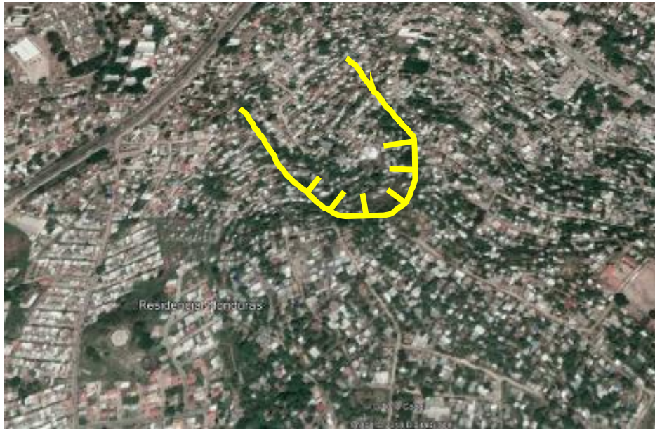
Figura 4: Situación del deslizamiento interpretado por fotografía
