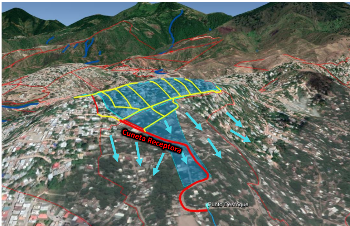
Ilustración 5 - Tramo de cuneta receptora
