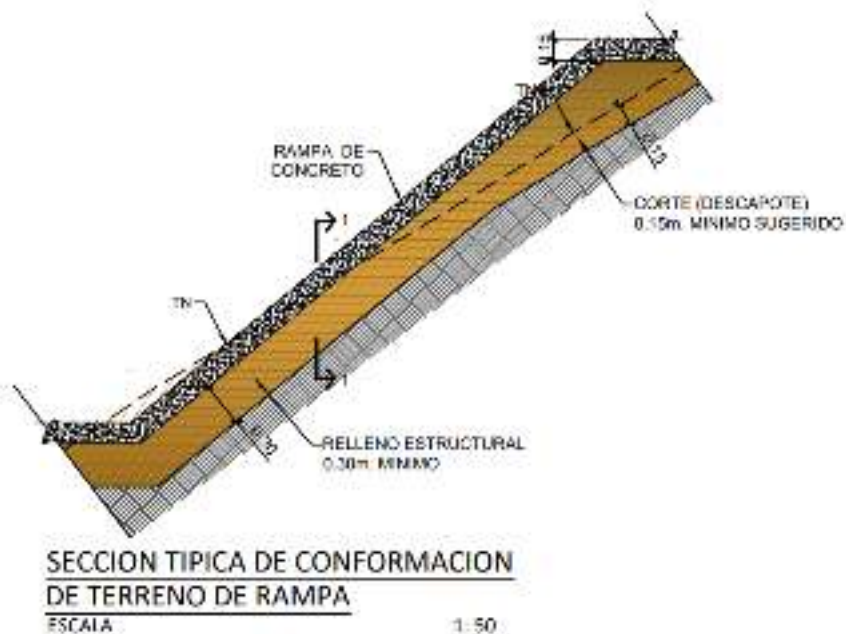
Ilustración No. 11 Sección típica rampa de concreto
