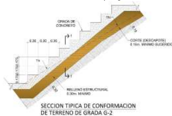
Ilustración No. 7 Sección típica grada G-2
