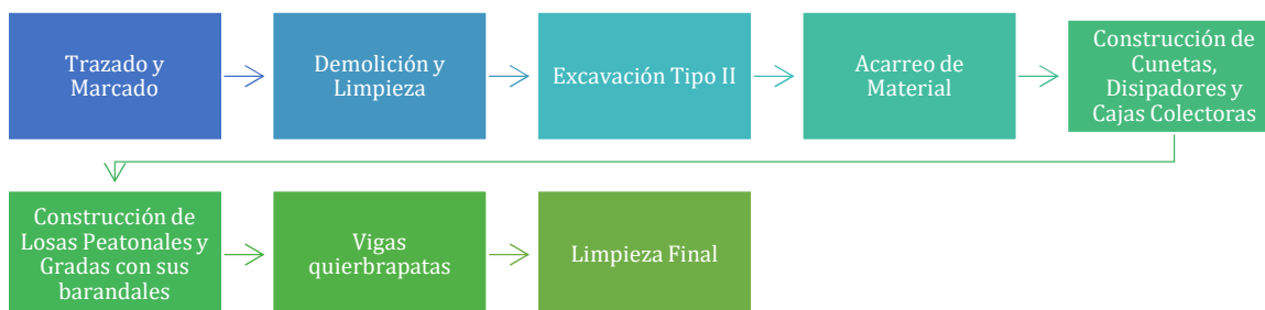
Figura 3. Actividades de Construcción del proyecto
