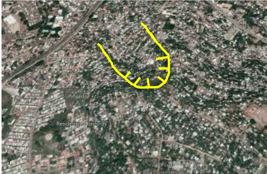
**Figura 4: Situación del deslizamiento interpretado por fotografía**
