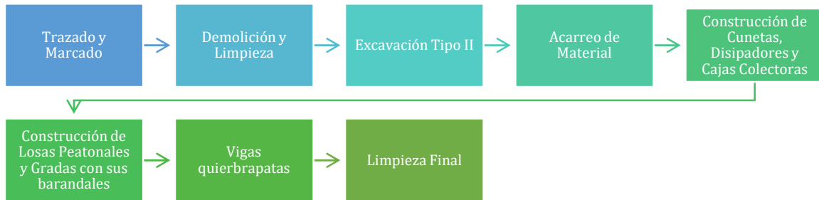
Figura 3. Actividades de Construcción del proyecto
