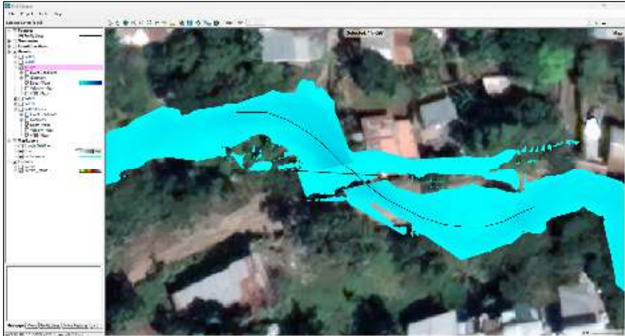
Figura 5. Resultados en RAS Mapper para la crecida máxima de un tiempo de retorno de 25 años
