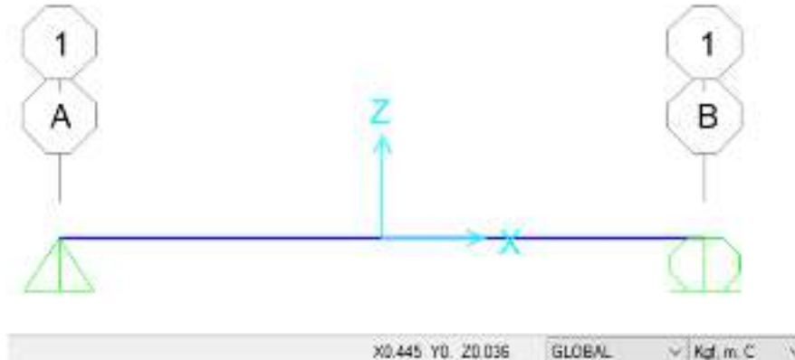
Figura 17: Modelo matemático de la viga. Longitud entre apoyos de L=1.10m
