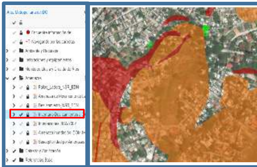
Figura 4: Mapa Deslizamiento JICA, representado por el color rojo escarpe, color naranja el deslizamiento sin embargo, no hay indicios que este activo. ( https://amdc.giscloud.com/ )
