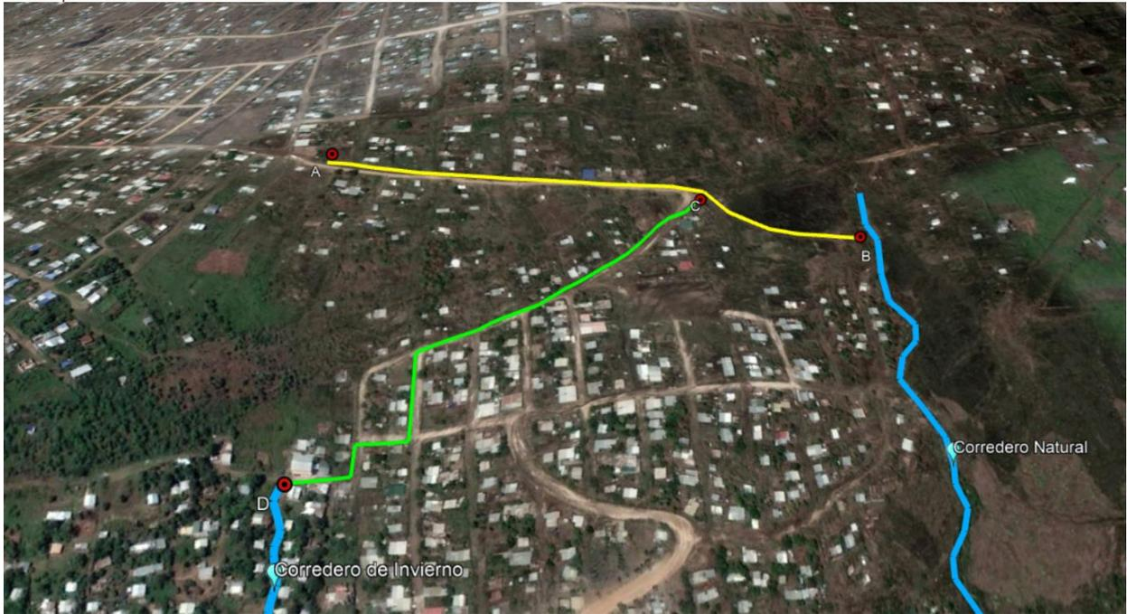
*Ilustración 7: Vista en Planta de Cunetas a Construir (Fuente: Google Earth)*
