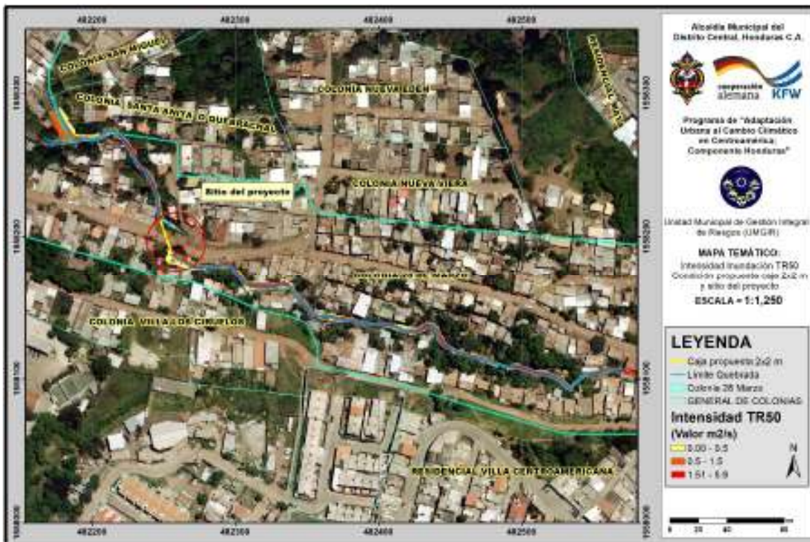
Ilustración 26. Mapa temático de profundidad de crecida de TR50 años para condición propuesta con caja de 2x2 m
