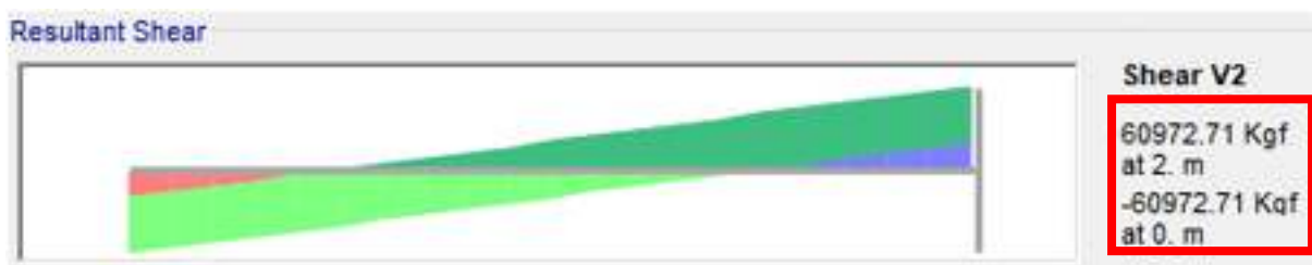
Figura 21: Diagrama de fuerzas cortantes (en kgf) para la combinación crítica considerada
