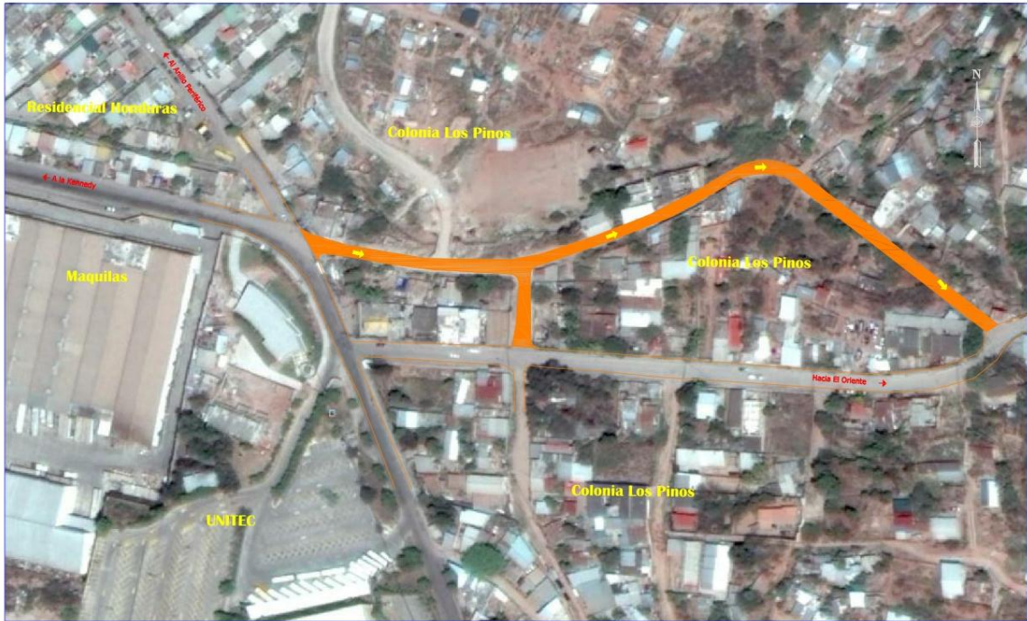
Estudio y Diseño para la Solución Vial Jacaleapa – Kennedy – UNITEC Pavimentación calles en Col. Los Pinos para readequación del tráfico de la zona
