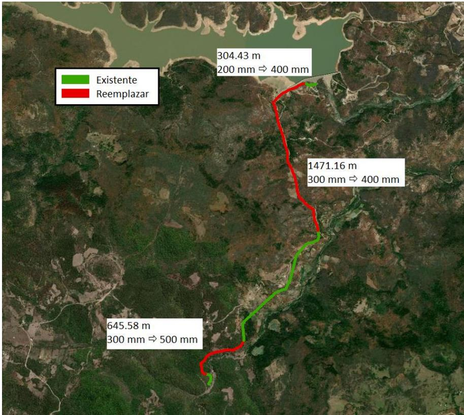
**Esquema de Reemplazo de tubería**
