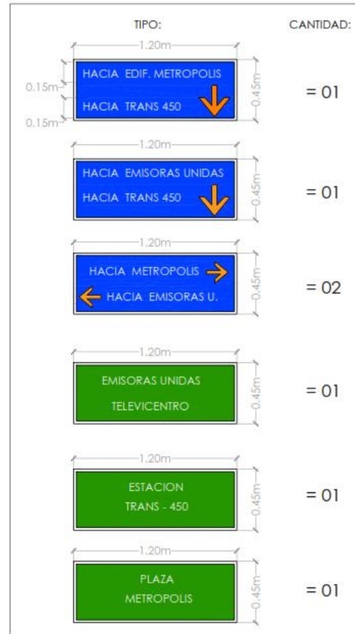
DETALLE DE ROTULACION Escala 1:30
