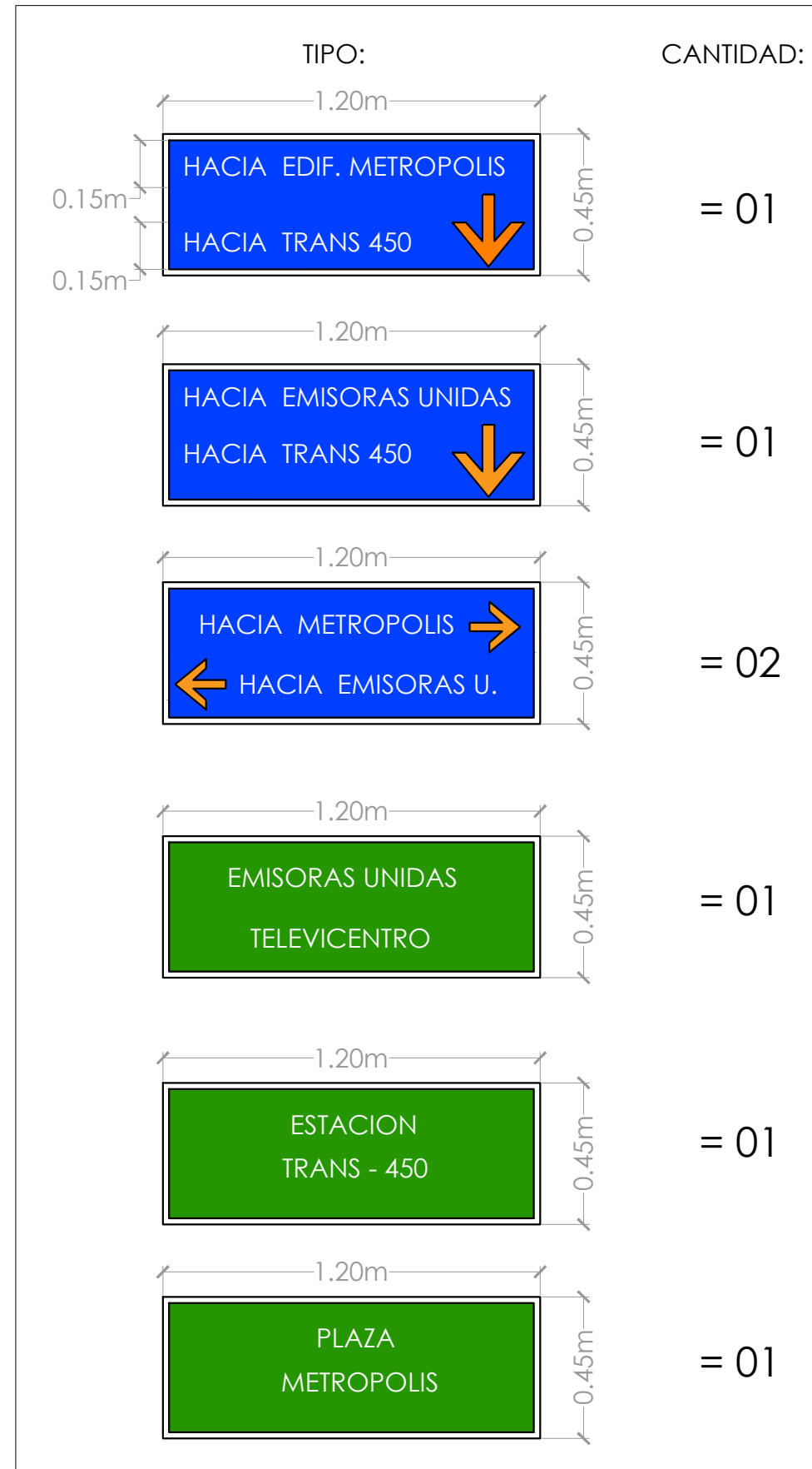
DETALLE DE ROTULACION Escala 1:30
