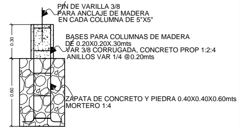
Z-2 DETALLE #2 CIMENTO PARA BASES INTERNAS
