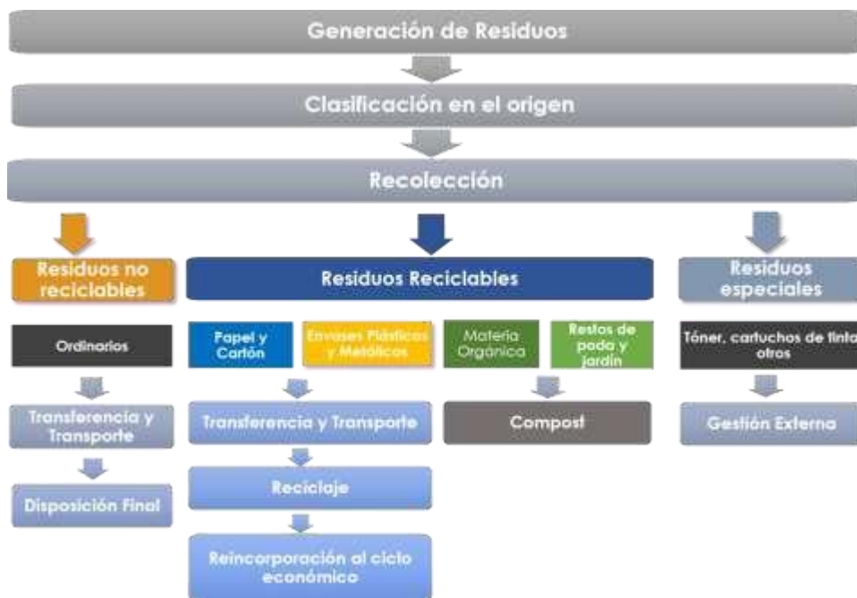
Figura 1. Diagrama del modelo de gestión de residuos sólidos a ser implementado en el Edificio Rectoría-Administrativo
